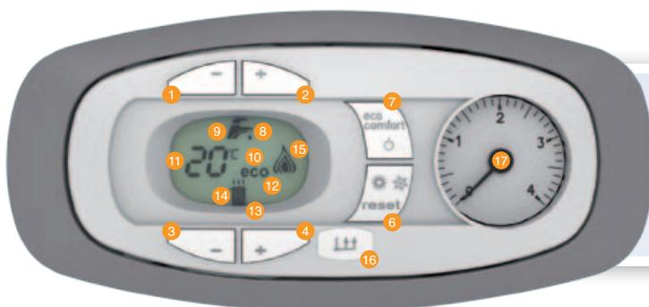
1-2 Regolazione temperatura acqua calda sanitaria 3-4 Regolazione temperatura impianto riscaldamento 6 Tasto Ripristino - selezione estate/inverno - Menù "temperatura scorrevole" 7 Tasto selezione economy/comfort e modalità OFF 8 Acqua calda SANITARIO 9 Modalità SANITARIO attiva 10 Modalità Estate 11 Indicatore multifunzione 12 Modalità ECO (Economy) 13 Modalità RISCALDAMENTO attiva 14 Acqua calda RISCALDAMENTO 15 Accensione e potenza del bruciatore 16 Connessione Service Tool 17 Idrometro
